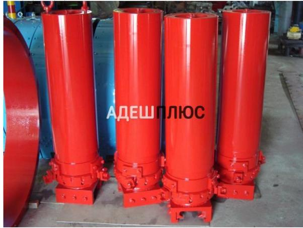
Гидродомкраты производства ООО «АДЕШ плюс», предназначены для подъема и удержания вышечного блока, его выравнивания в горизонтальной плоскости при проседании опор; применяются в механизме вывешивания для снятия нагрузки с колес при подъеме, выравнивании и фиксации мобильной буровой установки в процессе подготовки к бурению.
